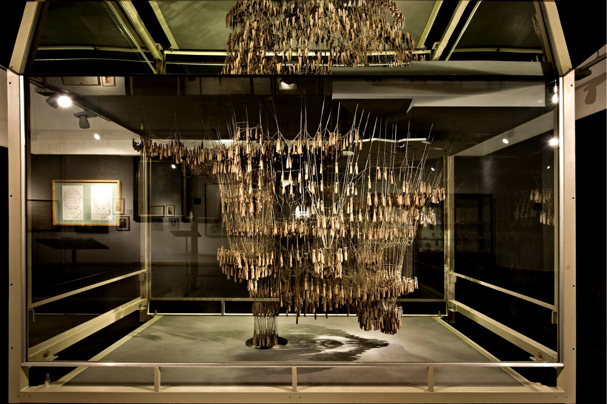
An upside-down rope model of Sagrada Família
